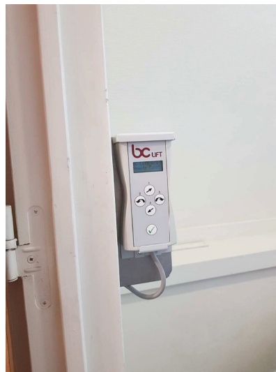
Et boîtier permettant à une tierce personne de faire la manoeuvre
